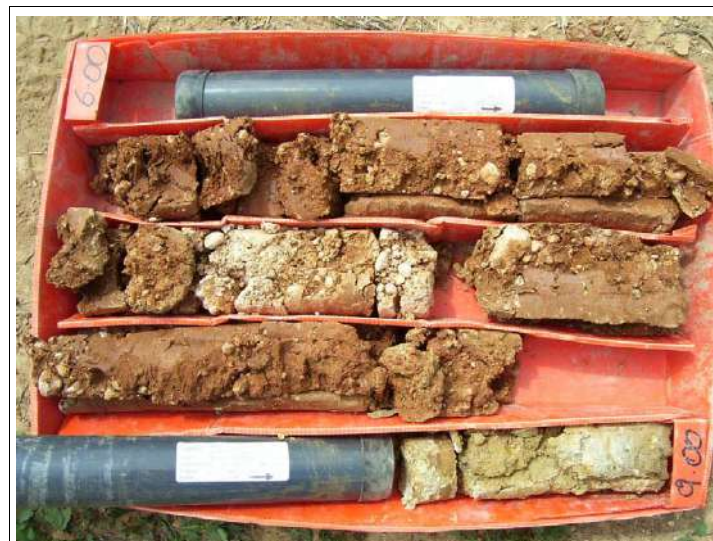
Fotografia 14. Material recuperat en el sondeig S-3 de 6.0 a 9.0 m.
