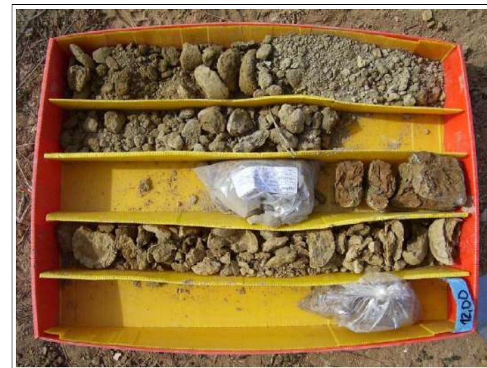
Fotografia 11. Material recuperat en el sondeig S-2 de 9.0 a 10.20 m.
