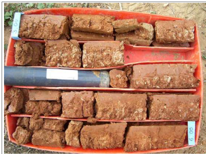
Fotografies 13. Material recuperat en el sondeig S-3 de 3.0 a 6.0 m.
