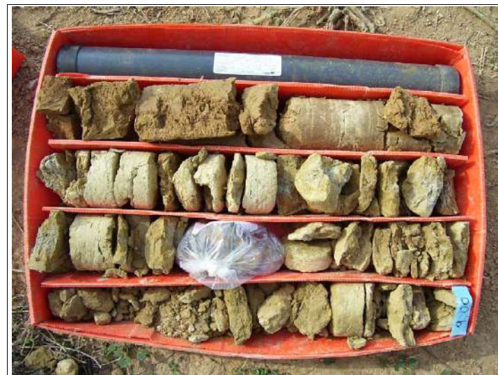
Fotografia 10. Material recuperat en el sondeig S-2 de 6.0 a 9.0 m.
