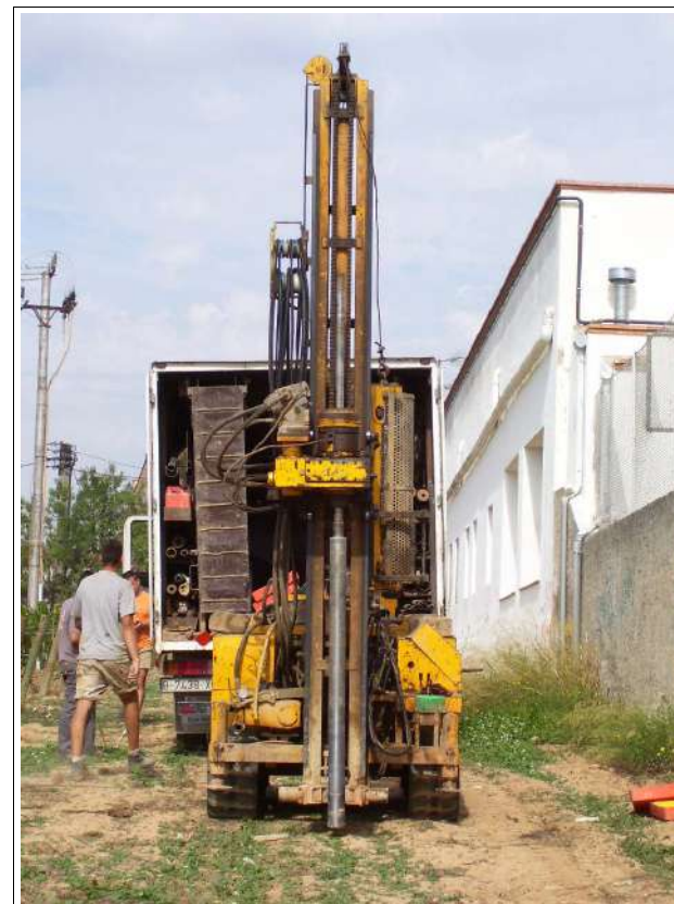
Fotografia 3. Màquina de rotació realitzant el punt S-3.
