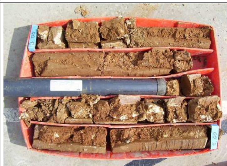
Fotografies 5. Material recuperat en el sondeig S-1 de 3.0 a 6.0 m.
