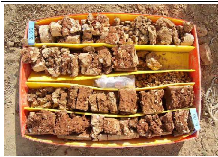
Fotografies 9. Material recuperat en el sondeig S-2 de 3.0 a 6.0 m.
