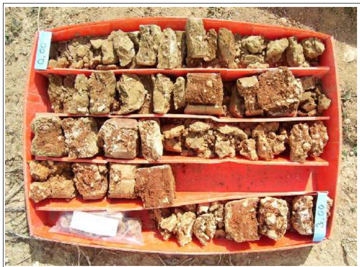
Fotografia 8. Material recuperat en el sondeig S-2 de 0.0 a 3.0 m.
